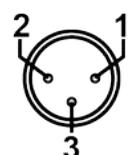
Todas las luces de Chauvet utilizan un pin 2 negativo y un pin 3 positivo, así que el conmutador de polaridad se debe configurar como se indica arriba y en [Vista del Panel Posterior](#) (hacia el puerto de salida de Control DMX). Los productos de otros fabricantes podrían ser distintos. Vea el Manual de Usuario de cada producto concreto para información específica.
