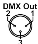
Alle Beleuchtungsgeräte von Chauvet verwenden einen negativen Pol 2 und einen positiven Pol 3, sodass der Polaritätsschalter wie oben und unter [Ansicht des rückwärtigen Bedienfelds](#) angezeigt eingestellt sein sollte (in Richtung des Anschlusses des DMX-Steuerungsausgangs). Beleuchtungsgeräte anderer Hersteller können davon abweichen. Spezifische Informationen finden Sie im Benutzerhandbuch der einzelnen Beleuchtungsgeräte.
