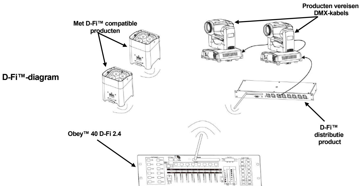
**DMX-addressering** De Obey™ 40 D-Fi 2.4 gebruikt DMX-addressering. Het bord bedient de lampen met specifieke DMX-adressen en de lampen moet correct zijn geadresseerd wil het bord ze kunnen bedienen. Meer dan één lamp kan hetzelfde DMX-adres bedienen, maar de lampen met hetzelfde DMX-adres moeten hetzelfde type lamp hebben.
