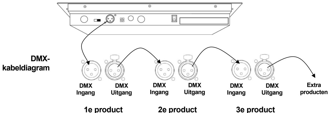
**D-Fi™-communicatie** D-Fi™-communicatie kan los worden gebruikt of in combinatie met DMX-bekabeling. Producten die compatibel zijn met D-Fi™ ontvangen D-Fi™-signalen direct van de Obey™ 40 D-Fi 2.4, en producten die DMX-bekabeling vereisen kunnen direct worden verbonden aan D-Fi™-distributieproducten, zoals D-Fi™ Hub en D-Fi™ Stream 6 die het D-Fi™-signaal ontvangen en het uitzenden via DMX-kabels.
