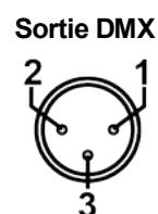
Tous les projecteurs Chauvet utilisent une broche négative 2 et une broche positive 3. Le commutateur de polarité doit donc être positionné comme montré ci-dessus dans la [Vue du Panneau Arrière](#) (à côté du port de sortie de contrôle DMX). Les appareils d'autres fabricants peuvent être différents. Consultez le manuel de l'utilisateur de chaque appareil pour des informations spécifiques.
