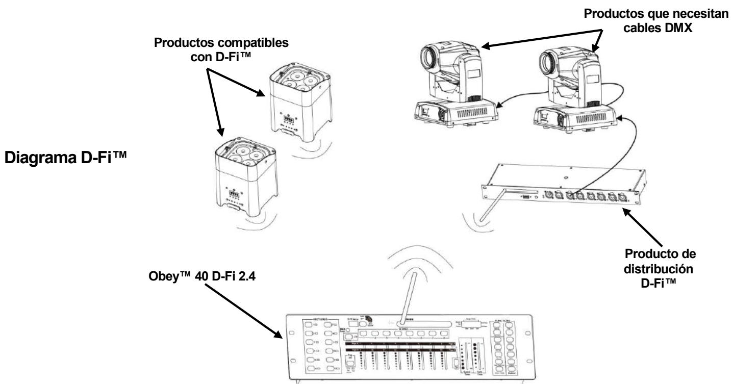
**Asignación de Direcciones** El Obey™ 40 D-Fi 2.4 utiliza direcciones DMX. La mesa controla las luces con direcciones DMX específicas y estas direcciones han de asignarse correctamente a las luces para que la mesa las controle.
