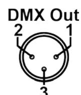
Alle lampen van CHAUVET® gebruiken een negatieve pin 2 en positieve pin 3, dus moet de polariteitsschakelaar worden ingesteld zoals is afgebeeld in [Achterpaneelaanzicht](#) (richting de poort DMX-regeluitgang). Producten van andere fabrikanten kunnen anders werken. Zie de gebruikershandleiding voor de individuele producten voor specifieke informatie
